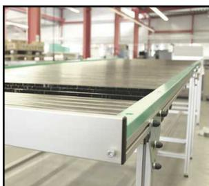
Die Abmessungen können individuell zwischen einer Breite bis max. 800 mm und einer Länge von max. 6000 mm gewählt werden.
