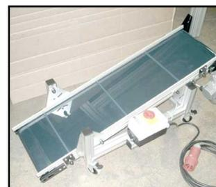
Die Unterkonstruktion wird mit stabilen Aluprofilen umgesetzt und ermöglichen den Bau von horizontalen, schrägen oder bei Bedarf sogar höhenverstellbaren Bandförderern.
