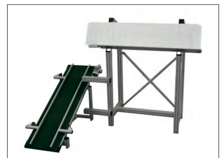
Przenośnik taśmowy z dobudową
