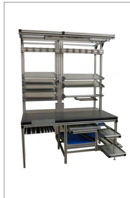
Stanowisko robocze z wysuwanymi półkami
