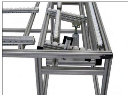
Aluprofil mit Zulaufbahn
