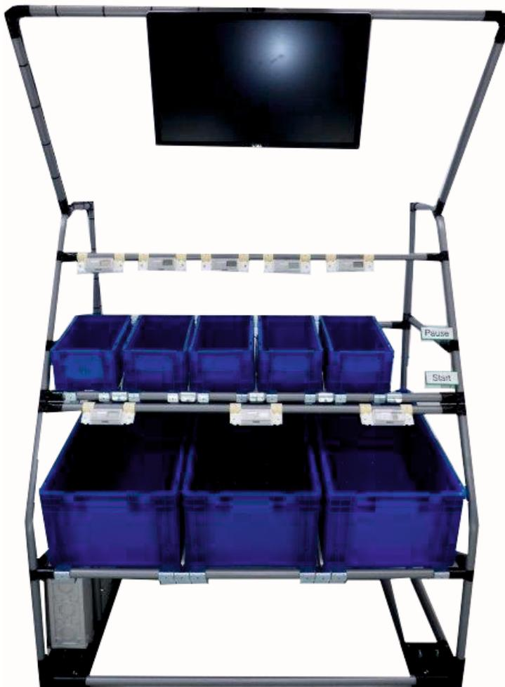
*Pick by Light System in Kombination mit einem ECO-Rohr Regal*
