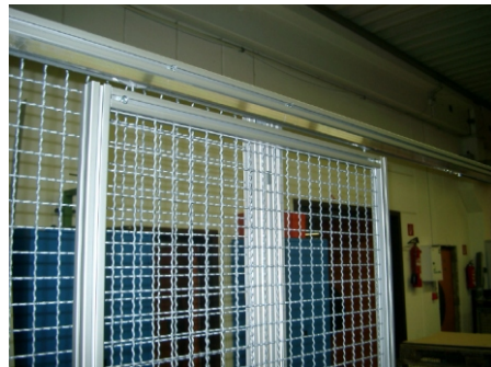
Schutzzaun mit Schiebetür
