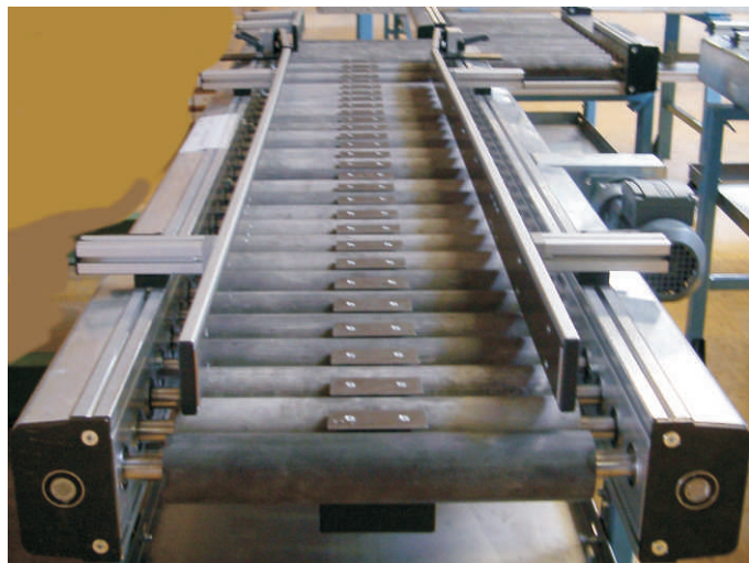
Friktionsrollenbahn mit verstellbarer Seitenführung
