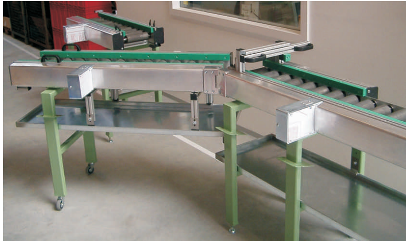
Friktionsrollenbahn mit schwenkbarem Durchgang
