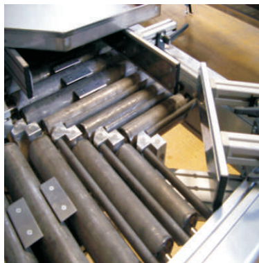
Eckstation für scheibenförmige Werkstücke
