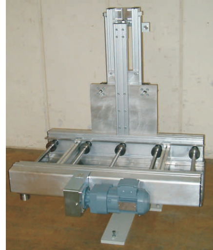
Frikitionsrollenbahn auf Hubstation
